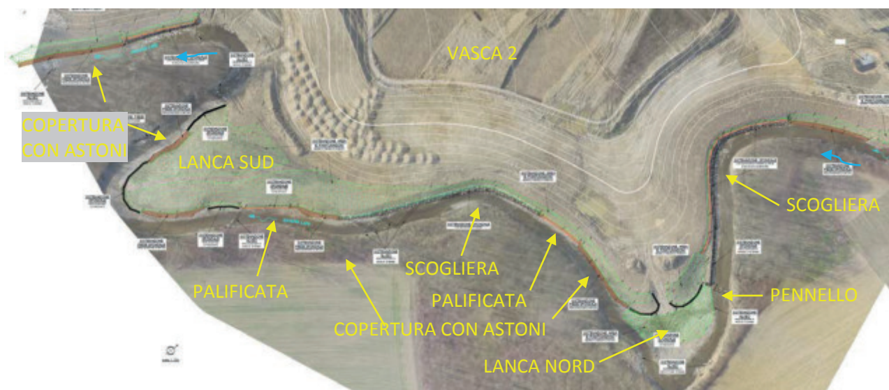
Figura 4 – Planimetria degli interventi di RF di progetto realizzati (immagine da drone, 2017). Sono evidenti i punti di rimozione e addolcimento delle lanche nord e sud e gli altri interventi, tra cui i tratti ove è stato necessario intervenire con un consolidamento delle sponde a ridosso degli argini.
