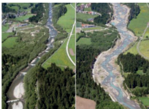
Figura3 – Rio Mareta all'altezza di Stanghe, prima (a sinistra; 2005) e dopo (a destra; 2011) i lavori di riqualificazione.
