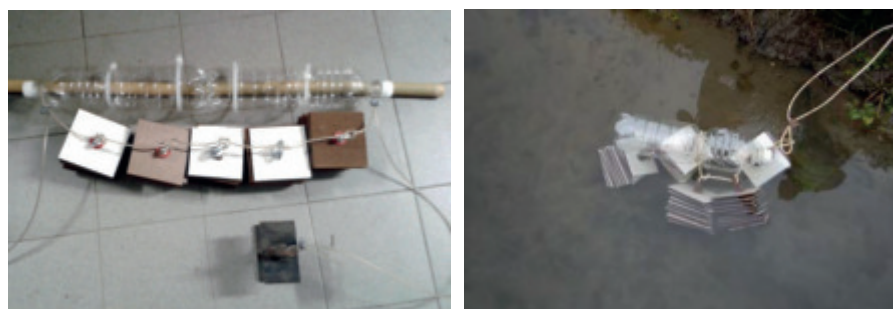
Figura 2: Struttura del substrato artificiale per la cattura degli organismi macrobentonici e messa a dimora in alveo
